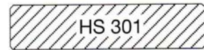
HS 301 Glattkantbrett, dreis. rechth. gehobeit, Rückts. mit Schlaghobel, alle Kanten mit kleiner Fase
